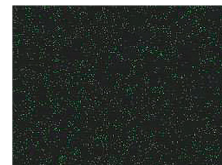
塗料中の二酸化チタンEDX観察結果。光触媒がまんべんなく散らばっている
