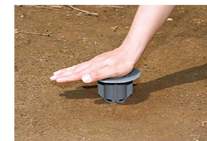
餌の状況とシロアリの活動状況をオペレーターが定期的にチェック
