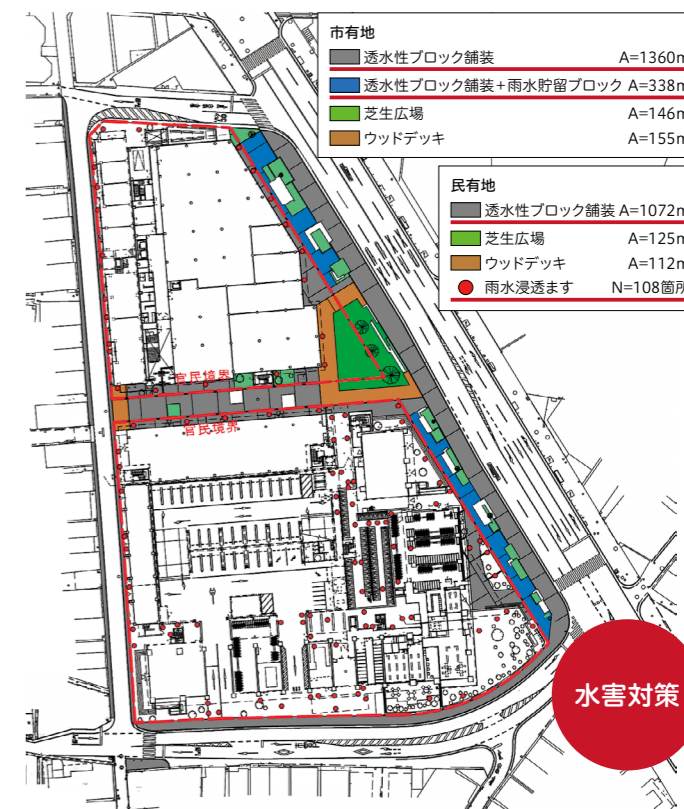
透水性ブロック・雨水貯留ブロック・雨水浸透ますを設置して雨水処理能力を強化（水害対策）
